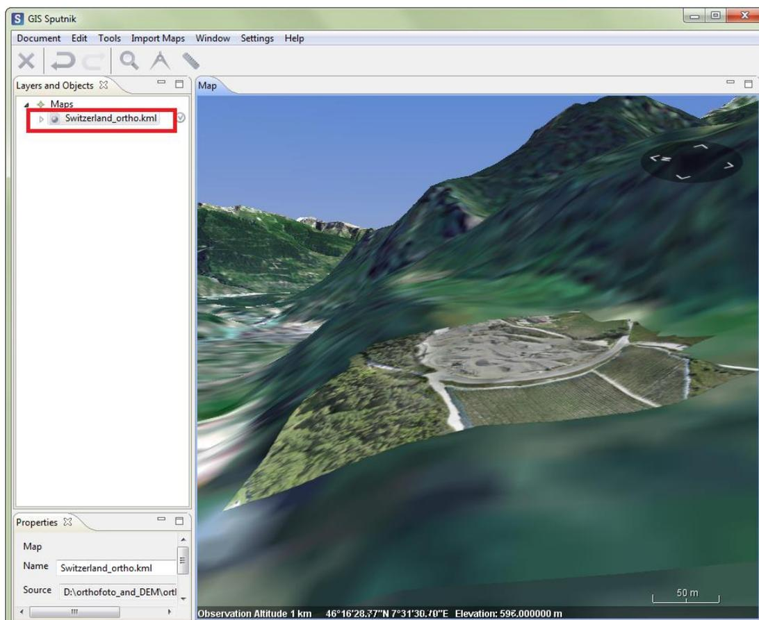
По умолчанию ортофотоплан совместится с текущим рельефом SRTM в Спутнике. Рельеф SRTM имеет пространственное разрешение 90 м и разрешение по высоте 1 м. Для просмотра рельефа с высоким разрешением загрузите локальную цифровую модель местности:
