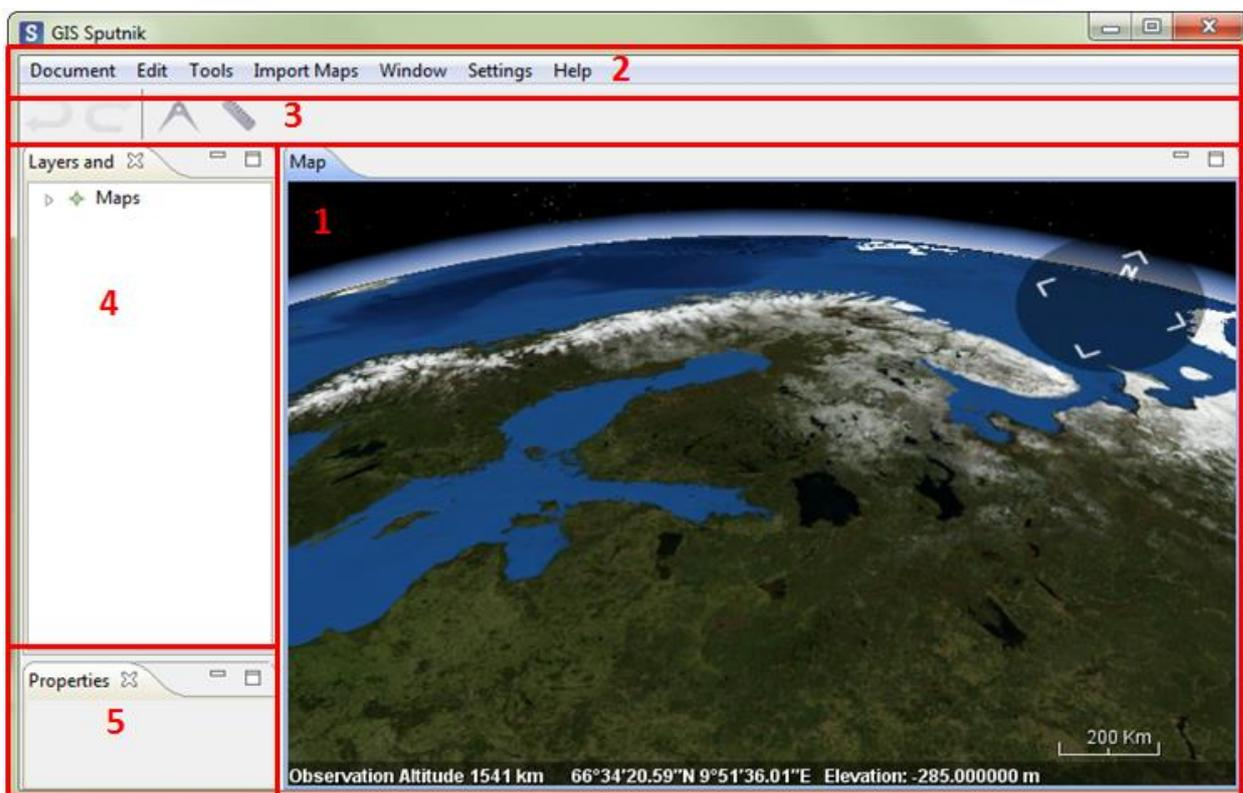
Интерфейс пользователя ГИС Спутник состоит из картографического окна (1), пунктов меню (2), панели инструментов (3), окна «Maps» (4), а также окна Properties (5).
